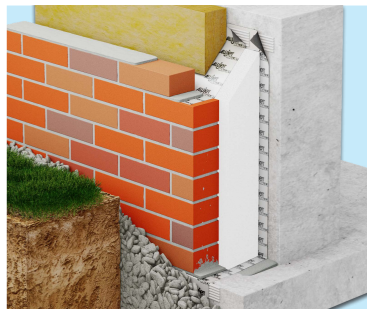
Im zweischaligen Mauerwerk auf Beton
