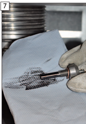
7 Verbindungselement von außen reinigen.
