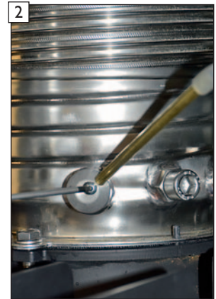
2 Fixierschraube am Anschluss des Druckmessschlauches lösen.
