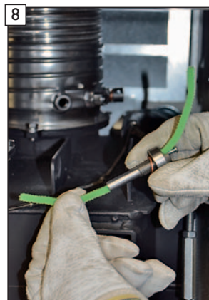
8 Messkanal des Verbindungselementes von innen reinigen.
