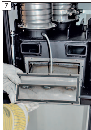
7 Revisionsverschluss in umgekehrter Reihenfolge wieder einbauen.
