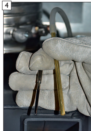
4 Temperaturfühler und Messingröhrchen aus den Anschlusschrauben entfernen.
