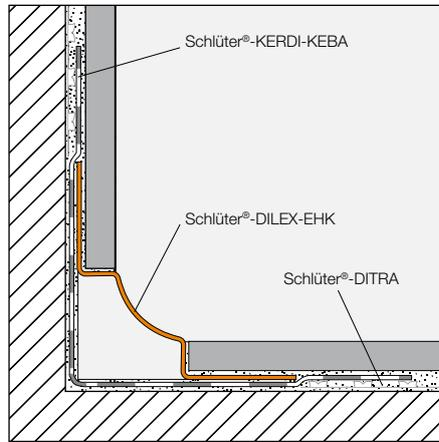
Abb. 3: Boden-Wand-Übergang
