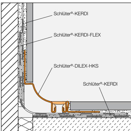
Abb. 4: Boden-Wand-Übergang
