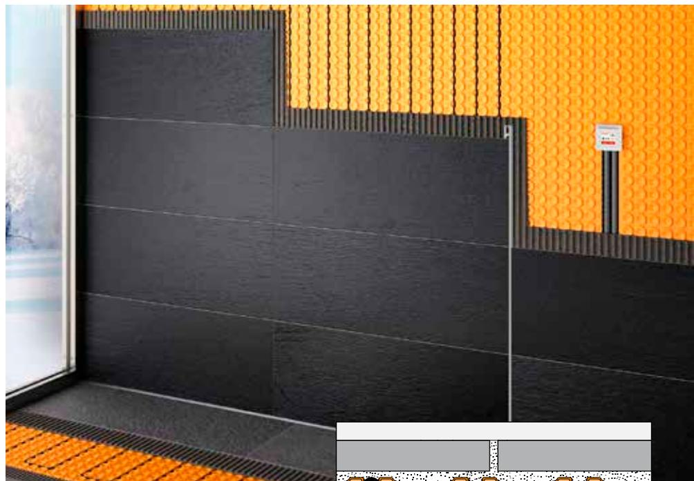
Der Fliesenbelag wird entsprechend der geltenden Regelwerke fachgerecht im Dünnbettverfahren direkt auf DITRA-HEAT verlegt, wobei sich der Dünnbettmörtel in die hinterschnittene Noppenstruktur der DITRA-HEAT Matte verankert.
