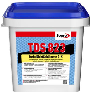
Schnell abbindende, zweikomponentige, flexible, mineralische Hochleistungs-Dichtschlämme (MDS) zum Erstellen von rissüberbrückenden Abdichtungen. Zur Abdichtung von Balkonen, Loggien und Laubengängen gemäß DIN 18531 Teil 5, zur Abdichtung von erdberührten Bauteilen gemäß DIN 18533, zur Abdichtung von Innenräumen gemäß DIN 18534 sowie zur Abdichtung von Behältern und Becken gemäß DIN 18535.
