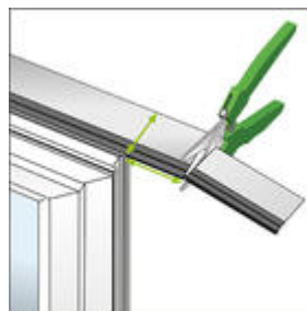
Bild 7: Folie im Eckbereich mit einem Breitenüberstand abschneiden
