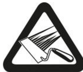
Bild 15: Bedeutung Symbol = überputzbare Seite Wandbefestigungsflächen bei Klebungen Die Haftflächen müssen trocken, frei von Öl, Fett, Staub und sonstigen antiadhäsiven Bestandteilen sein. Die Kombination von selbstklebenden Bändern mit Dichtstoffen, die nicht Bestandteil des illbruck Systems sind, kann zu Wechselwirkungen führen. Die Verträglichkeit ist im Einzelnen zu prüfen. Grundlage für das Überputzen von Folien sind die Angaben in der Informationsschrift „Verputzen von Fensteranschlussfolien; Technisches Merkblatt Bundesverband der Gipsindustrie e.V.: Industriegruppe Baugipse“. Es sind Eigenversuche hinsichtlich der Haftung verschiedener Putze durchzuführen. Bei problematischen Ergebnissen ist die Wandbefestigung mit Einputzgewebe immer vorzuziehen.
