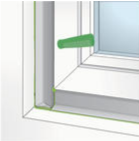
Bild 10: Überlappungen der Folien mit SP025 und Kederstöße mit OT015 verkleben
