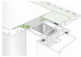
Bild 6: Befestigung der Folie innen wie Außenseite
