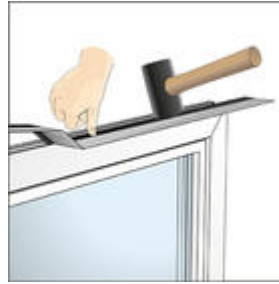
Bild 6: Geeignete Kederfolie in die äußeren Blendrahmen-Nuten einbringen
